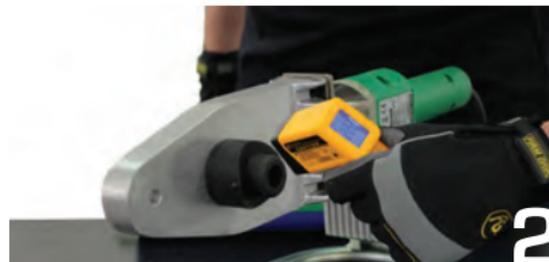
No olvide ajustar los cabezales después de que la placa se caliente y verificar la temperatura antes de comenzar.
