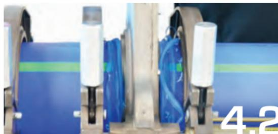
Acerque las dos tuberías a la herramienta de refrentado. Aumente la presión hasta que la herramienta de refrentado comience a desbarbar polipropileno. No aplique presión excesiva.
