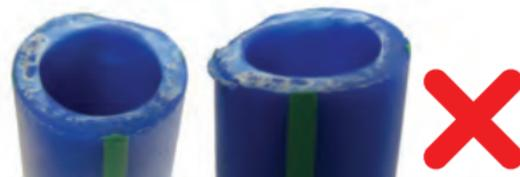
Las fisuras y marcas blancas indican daño. Vuelva a evaluar las herramientas de corte si dejan fisuras. Es posible que tenga que prensar el extremo de la tubería para detectar las fisuras pequeñas.
