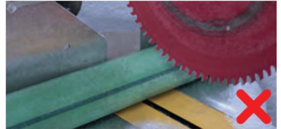
No utilice herramientas de corte eléctricas si la tubería está a 40°F o menos. La tubería fría puede fisurarse y dividirse. Entibie la tubería antes de cortarla.
