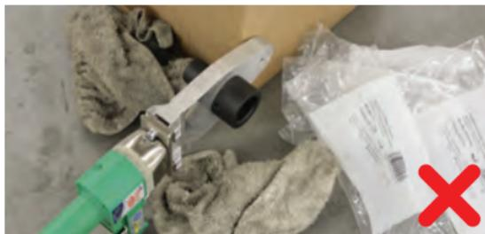
No deje que la plancha toque superficies inflamables o que se puedan derretir. Esto genera un peligro de incendio y puede dañar la placa o los cabezales.
