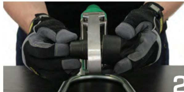
Instale los cabezales de fusión mientras la plancha se calienta. La placa se expandirá a medida que se va calentando y dejará mellas si los cabezales quedan demasiado ajustados.
