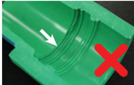
Una inserción insuficiente debilitará la conexión y reducirá la extensión de la superficie de fusión.
