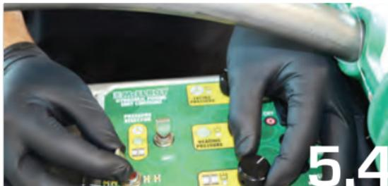
Acerque las tuberías a la plancha de calentamiento a la presión total para que comience a formarse el cordón de ajuste.
