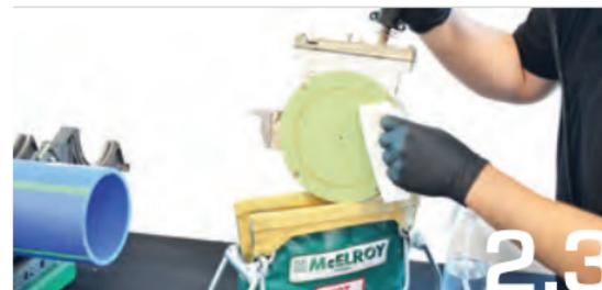
Antes de la fusión, limpie la **plancha** para eliminar la suciedad, el polvo, los residuos y demás contaminantes y luego limpie con un paño limpio y alcohol isopropílico (91% o superior).
