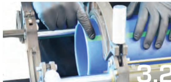
Deje un reborde de ½-1 pulg. (más si el corte es irregular). El ancho de un pulgar es normalmente una buena medida. Deje suficiente espacio para la herramienta de refrentado.
