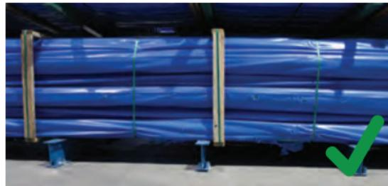
Mantenga la tubería sobre una superficie plana o acerque los soportes para evitar que se arquee. Utilice al menos tres soportes para todas las tuberías.
