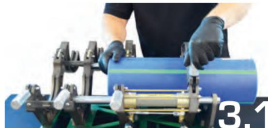
Coloque la tubería o el accesorio en las abrazaderas. De ser posible, use al menos dos abrazaderas para cada segmento de tubería. Haga los ajustes necesarios.
