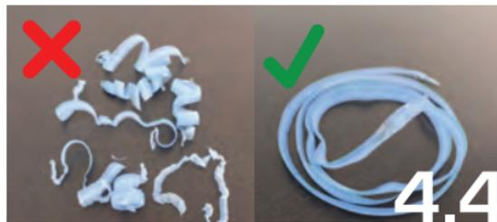
El refrentado correcto producirá tiras del ancho total a ambos lados en 360°. En este punto, abra el carro para separar las tuberías mientras la herramienta de refrentado todavía esté en movimiento. Ajuste la herramienta si un lado está listo antes que el otro.
