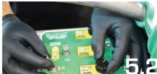
Ajuste el nivel máximo de presión de fusión (consulte a continuación lo relacionado con la presión de arrastre negativo). Los controles varían según el fabricante. No cambie esta presión luego de ajustarla.
