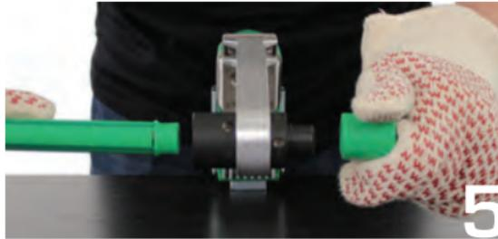
Quite el accesorio y la tubería de los cabezales de fusión. Utilice un soporte para fijar o pida ayuda para mantener la plancha en la posición correcta.
