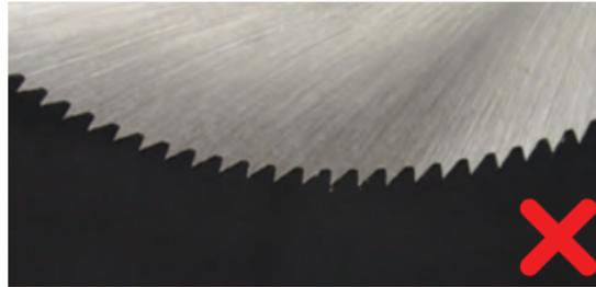
Una cuchilla de dientes finos (180T) sobrecalienta la tubería, debido a su corte excesivamente lento. Realice el corte lo más rápido y recto que sea posible.
