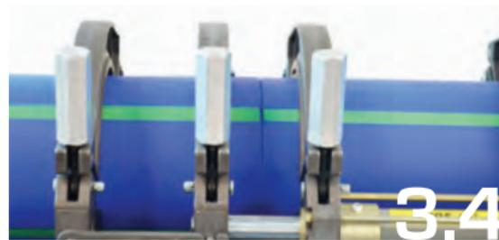
Ajuste las abrazaderas y junte los extremos de la tubería. Asegúrese de que no haya manos cerca del carro mientras esté en movimiento.
