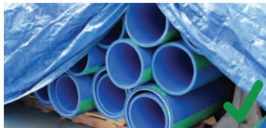
Cubra la tubería sin envolver con una lona de color claro si la guarda a la intemperie. Una lona de color oscuro genera calor y puede deformarla.
