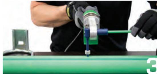
Inserte el cabezal de reparación en la plancha y la clavija de reparación en dicho cabezal. Caliente durante 5 seg.
