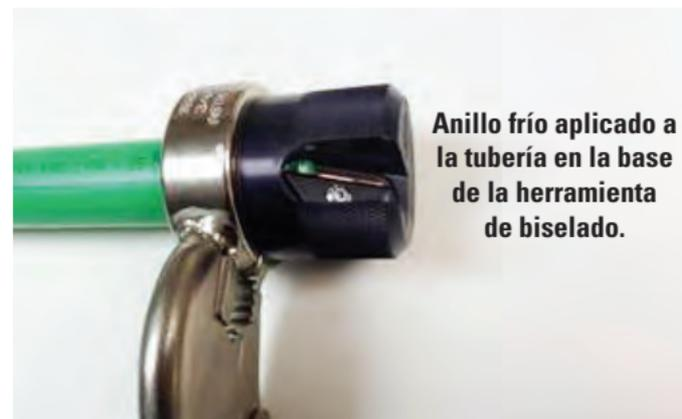
**Anillo frío aplicado a la tubería en la base de la herramienta de biselado.**
