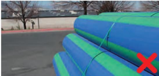
No guarde la tubería a la intemperie sin cubrirla. La tubería debe guardarse en su empaque de fábrica o cubierta por una lona de color claro.
