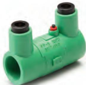
La electrofusión es particularmente útil cuando no hay espacio o movilidad suficiente para realizar una fusión a encaje tradicional. Sin embargo, la electrofusión tiene más pasos y es más difícil de inspeccionar visualmente. Por tanto, la opción de aplicar electrofusión en lugar de fusión a encaje tradicional depende de las restricciones físicas de la instalación y las preferencias del instalador. Pueden integrarse electrofusiones con fusión a encaje y a tope tradicional si es necesario.
