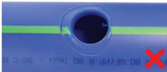
Si el cabezal de fusión no ha hecho una impresión completa, no coloque la salida en el orificio. No se logrará una fusión adecuada.
