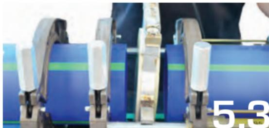
Abra el carro e inserte la plancha de calentamiento. Asegúrese de que la plancha esté a  $410 \pm 18^\circ\text{F}$  ( $210 \pm 10^\circ\text{C}$ ).
