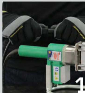
Una plancha demorará de 5 a 10 minutos en calentarse. De ser necesario, se pueden utilizar cables alargadores de bajo calibre para suministrar energía en distancias prolongadas. Si utiliza una fuente de alimentación limitada, tenga en cuenta los demás dispositivos que consuman energía porque pueden causar fluctuaciones de temperatura. Un protector de sobretensión protegerá la plancha contra sobrecargas eléctricas en el sitio de trabajo.
