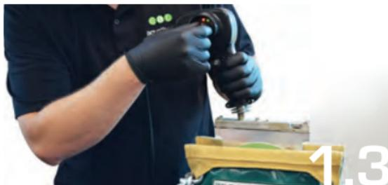
Inspeccione y encienda la plancha de fusión. Asegúrese de que esté limpia y ajustada en 410°F (210°C) +/- 18°F. Verifique la temperatura correcta antes de cada fusión.
