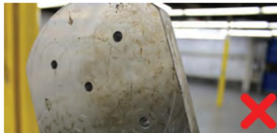
No use la plancha de fusión si la placa o los cabezales están sucios. Limpie la placa con un cepillo de alambre suave y los cabezales con un paño.
