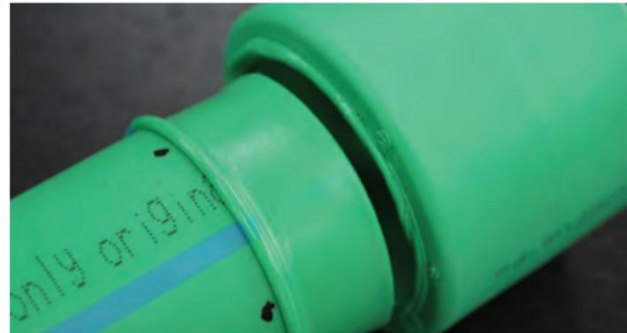
El proceso de calentamiento permite insertar la tubería en el accesorio. La pared interna de este último se fusiona a la pared externa de la tubería para formar una unión igual de resistente que la misma tubería. La conexión se forma en toda la superficie fusionada.
