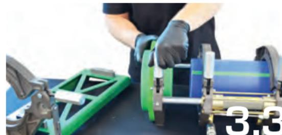
Reubique las abrazaderas para que quepan los accesorios según sea necesario. Algunas abrazaderas se deslizan y otras pueden retirarse completamente.
