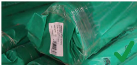
Mantenga la tubería en su envoltura protectora hasta que esté listo para instalarla. La bolsa protege la tubería de suciedad y rayones.
