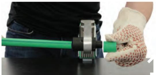
1 Limpie la tubería e insértela junto con el accesorio en el cabezal de fusión. Presionar ambos lados al mismo tiempo ayuda a sostener firmemente la plancha.
