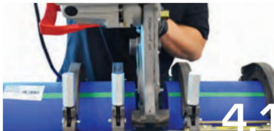
Abra el conjunto del carro y bloquee la herramienta de refrentado. Encienda la herramienta de refrentado y deje que alcance la velocidad máxima. Nunca encienda la herramienta de refrentado si está atrapada entre las tuberías.
