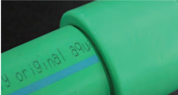
Las dimensiones de los accesorios son demasiado pequeñas para acoplarse a la tubería sin aplicar calor. Por este motivo la conexión en seco es imposible, de modo que no deben quedar conexiones sin fusionar por accidente. Asimismo, la diferencia de diámetro entre el accesorio y la tubería genera la presión requerida para la fusión.
