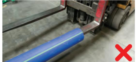
No inserte objetos filosos o sin protección en los extremos de la tubería. Pueden enterrarse en la tubería y crear puntos débiles.
