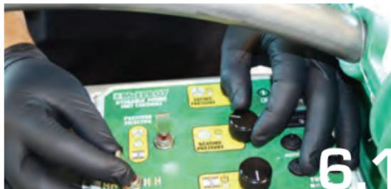
Cuando se complete el cordón de ajuste, baje la presión del sistema al nivel de arrastre. De ser necesario para mantener el contacto, agregue hasta un 10% de la presión de la máquina.
