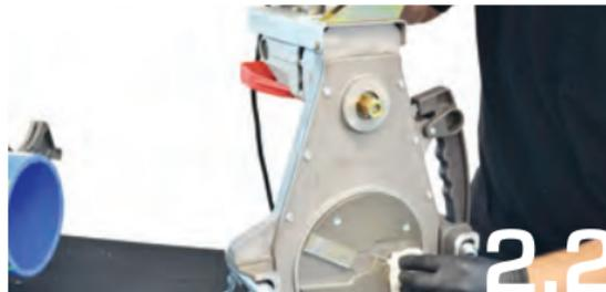
Antes de la fusión, limpie la **herramienta de refrentado** para eliminar la suciedad, el polvo, los residuos y demás contaminantes y luego limpie con un paño limpio y alcohol isopropílico (91% o superior).
