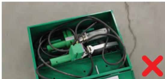
No guarde varias planchas en una sola caja. Las planchas pueden dañarse entre sí con facilidad y deben almacenarse por separado.
